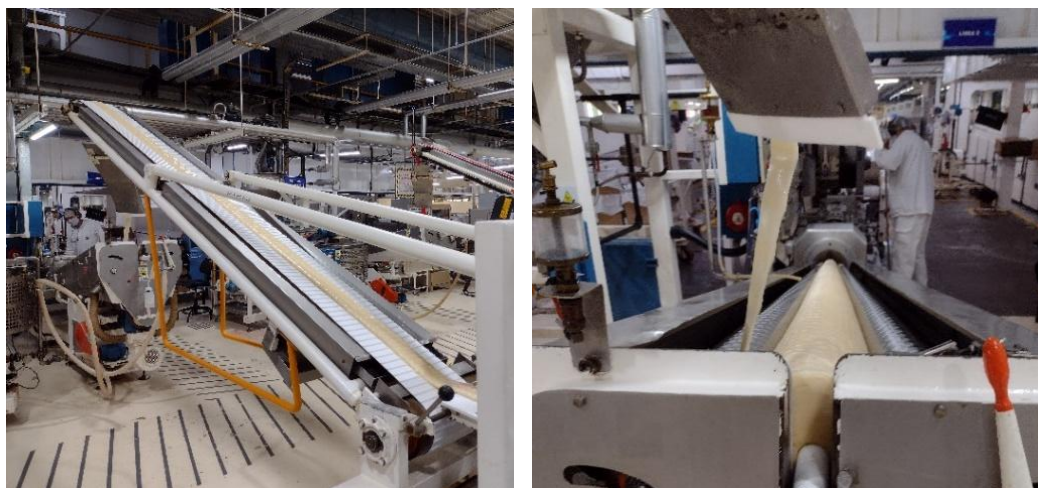
Imagen 6. Elevación de la cinta de caramelo y caída en la bastonadora.
