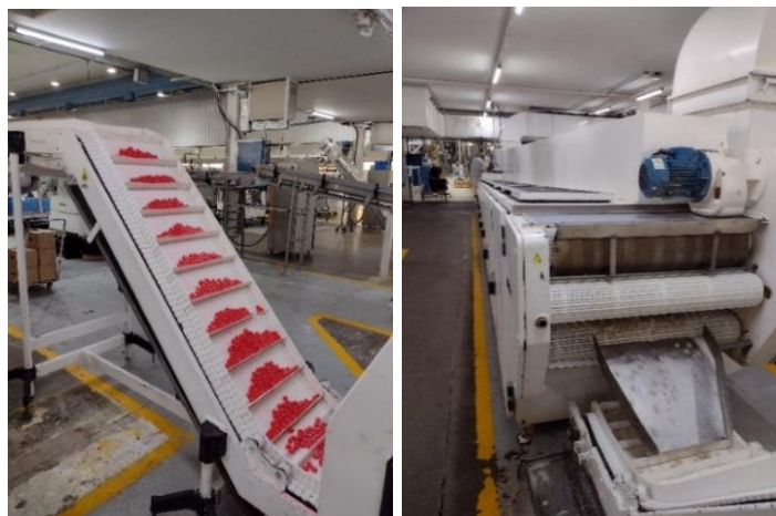
Imagen 7. Salida del caramelo del túnel de frío y elevación a cinta superior.
